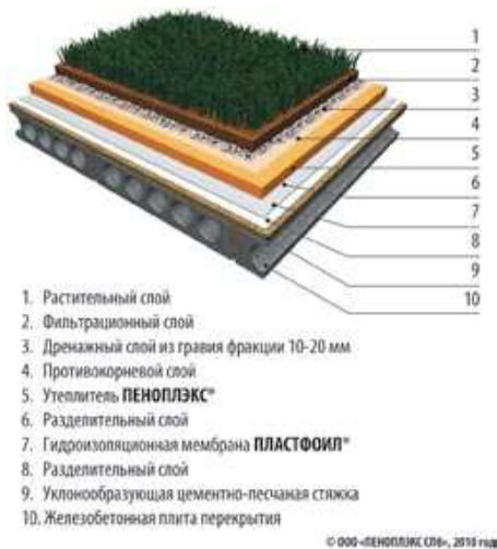
(圖三) 綠化倒置式上人屋面
